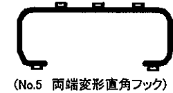
(b) 中間帯鉄筋形状
