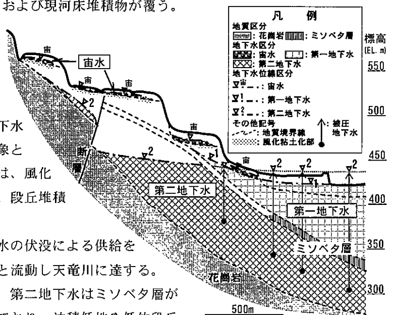
図-2 豊丘村の水文地質構造概念 (断面線位置は図-3 参照)
