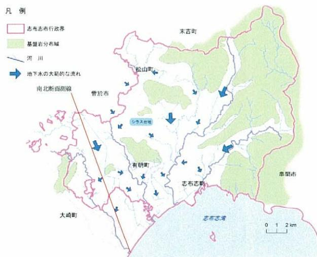
図-4 想定される第1帶水層の地下水流動方向
