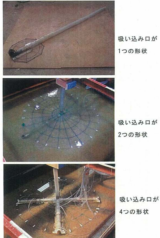
図-4 パイプおよびシートのレイアウト例
