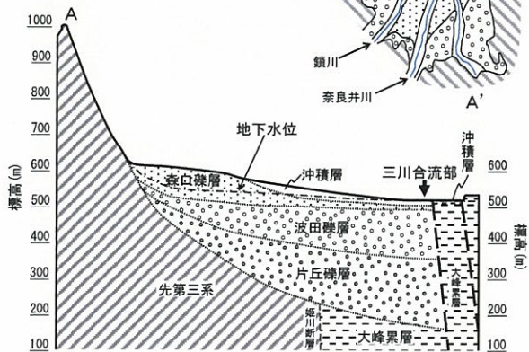
図-2 松本盆地の想定地質断面
