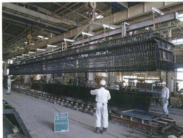
写真 - 7 U形プレキャスト桁の制作
