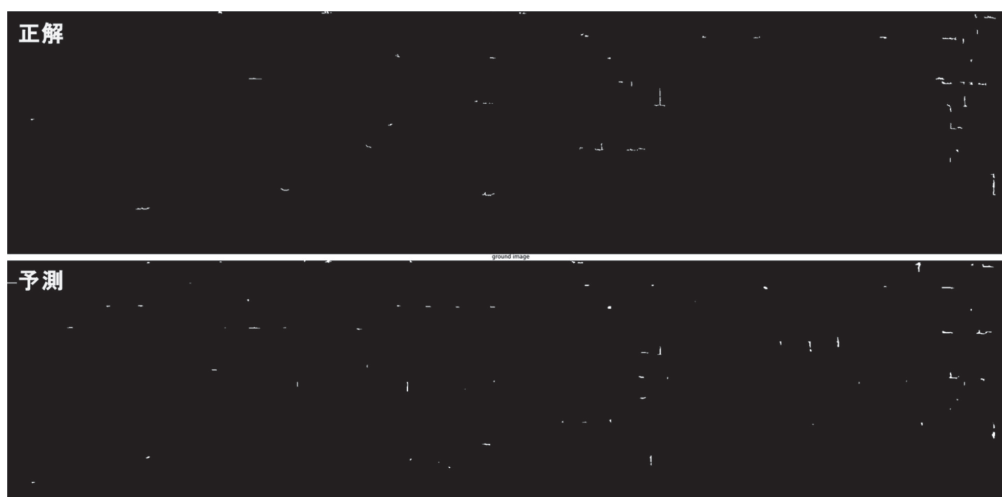
図一7 ヒビが少ない区間の計算結果の再現精度（上段：土木技術者描画ヒビ，下段：AI生成ヒビ）
