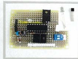
写真5 各種センサー及び、制御部
