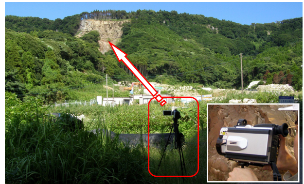
写真-2 熱赤外線映像撮影状況(図-1: C地点)
