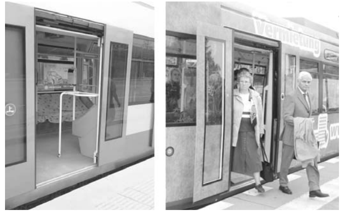
図-5 トラムドア部とホームの段差（右はベルリントラム）
