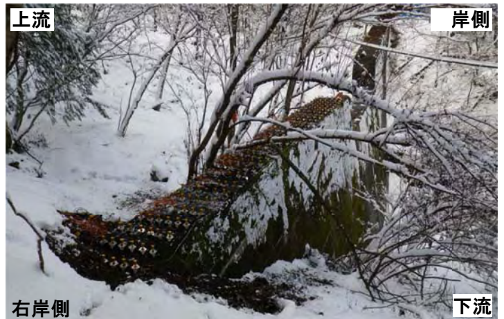
写真-1 受振器群の展開状況（右岸側から左岸側を望む）
