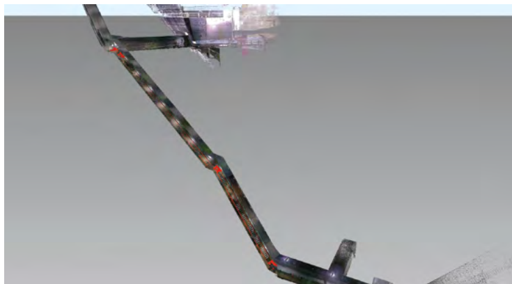
ダム監査廊内の排水ポンプ更新設計で作成した点群データと機械設備CIMモデルとの統合モデル(資料提供:国土交通省)
