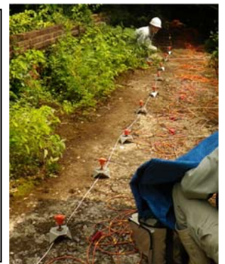
図-1 弾性波探査（改良型）の概念図（左）および天端における発振・受振状況（右）
