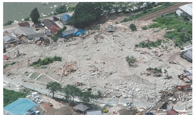
写真-7 土石流の氾濫堆積域の状況 流木が散在しているが木曾川本川に流出したものが多くあったと推測される（国際航業株式会社/株式会社パスコ・平成26年7月11日撮影）
