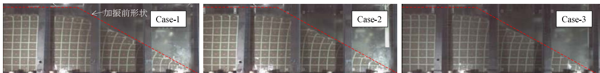
図-2 各ケースの 30G 加振後の変形状況
