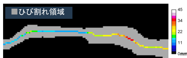
図-4 ひび割れ計測結果
