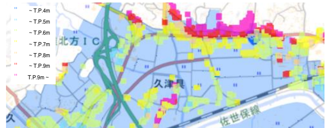
図-5 家屋の浸水調査から推定した浸水位
