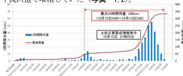
図-1 気象庁釜石観測所で観測された台風19号の1時間降水量と累加雨量
