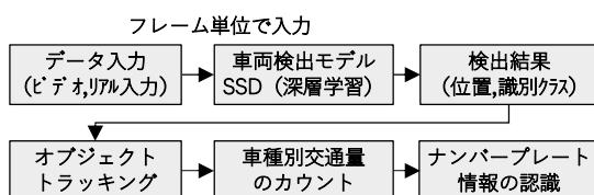
図 2 交通量計測およびナンバープレート認識の流れ
