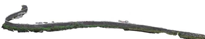
図-11 デジタルツインの例（鳥山川左岸 3 次元モデル）
