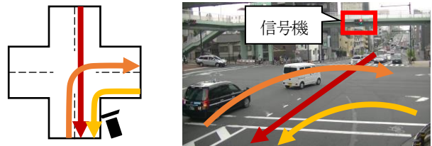
図-1 カメラ 1 台で計測対象とする 3 軌跡（カメラの断面に対して、直進車両、左折流出車両、右折流入車両）と信号機の位置。左図が俯瞰図、右図が実際の動画の撮影画角
