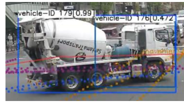
図-4 車両のパーツを一つの車両として検出し, 通過車両として計測した例
