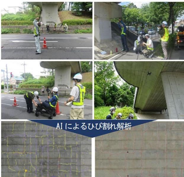
図-8 画像計測と AI によるひび割れ解析
