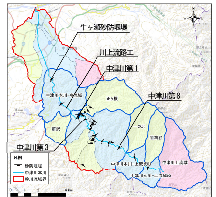
図-2 既存砂防施設位置(中津川)
