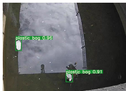
図-8 排水路の人工系ごみ判別例（Case3, 学習データ③, 2020年3月2日 10:20）
