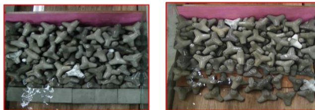
写真-2 消波ブロックの捕捉効果
