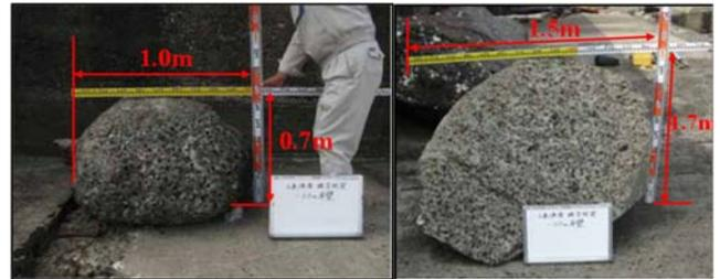
写真-3 打ち上げられた巨石(左)とコンクリート塊(右)
