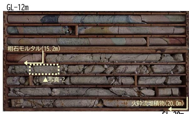
写真-1 T-14孔のボーリングコア写真
