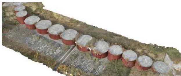
図6 覚生川1号砂防堰堤:3次元モデル
