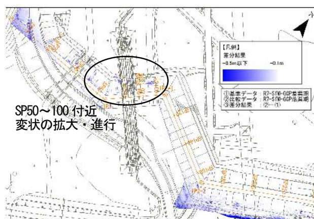
図12 R7SfM-GCPの2時期差分(SP20~SP220) (調査時期:着葉期:R7.8月、落葉期:R7.11月)
