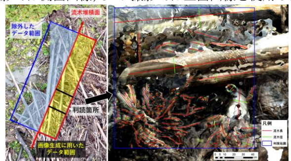
図-3 塚田川堆積流木群①の容積率計測結果（左：データ使用箇所、右：生成した側面画像）
