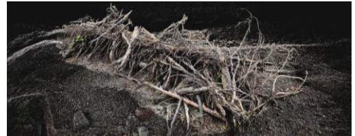
図-2 塚田川堆積流木群②の高密度点群データ
