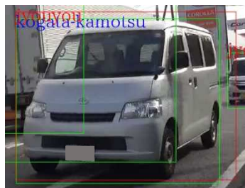
図-11 認識エラー事例（小型貨物車を小型乗用車と認識）
