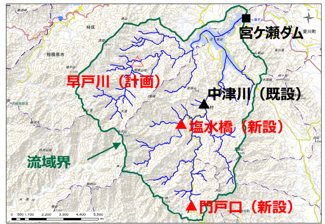
図-3 宮ヶ瀬ダム上流域の水位観測箇所
