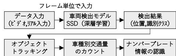
図-1 計測・認識の処理フロー
