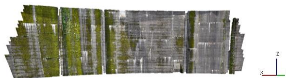
図-8 空撮位置座標のみによる三次元復元結果
